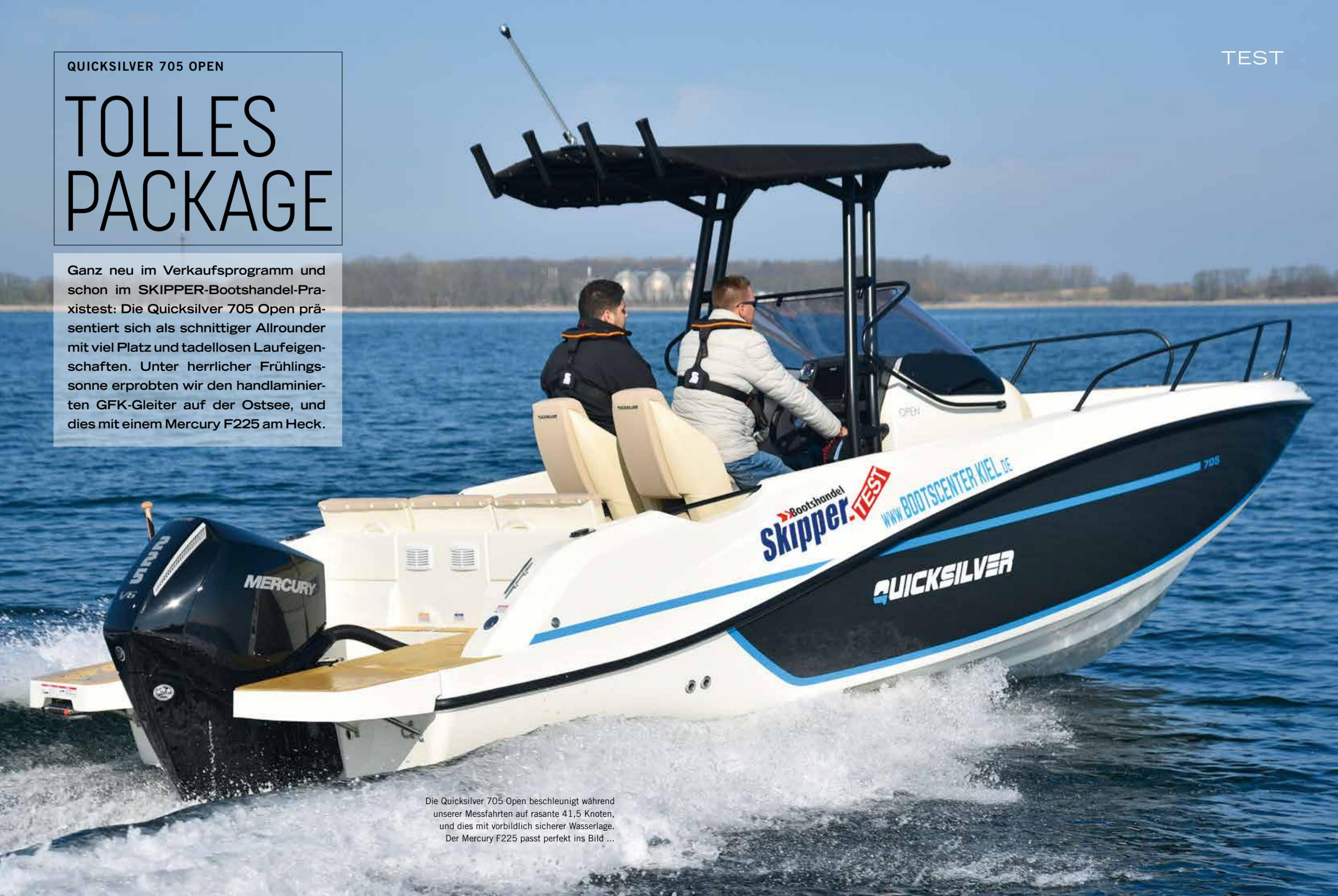
Die Quicksilver 705 Open beschleunigt während unserer Messfahrten auf rasante 41,5 Knoten, und dies mit vorbildlich sicherer Wasserlage. Der Mercury F225 passt perfekt ins Bild ...
